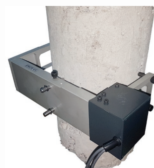
Экстензометр для определения поперечной и продольной деформации. Для расчета коэффициента Пуассона
