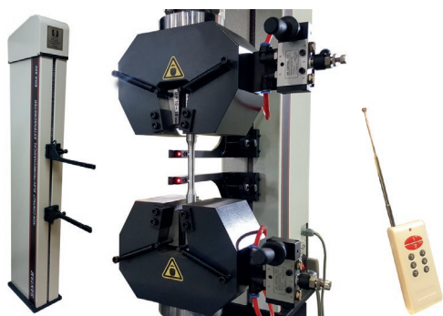
Бесконтактный автоматический экстензометр с сервоприводом Минимальная начальная длина 15 мм. Ход 800 мм
