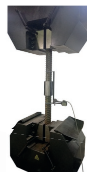
Навесной экстензометр Применимы различные начальные длины: 25, 50, 75, 100, 150, 200
