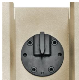
Рисунок 6. Ударный боёк по Шарпи.
