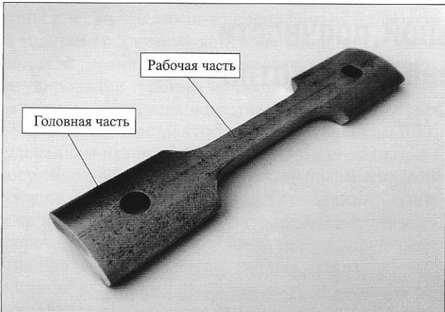
Рис. 1. Образец для испытания металла труб на длительную прочность
