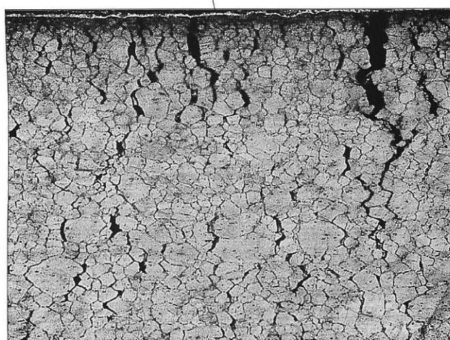
Рис. 3. Микроструктура и трещины ползучести после испытания стали марки ДИ59 на длительную прочность ( $\times 100$ )
