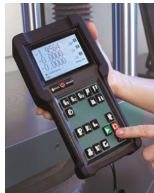
Проводной пульт с кнопочным управлением для операторов, работающих в перчатках.
