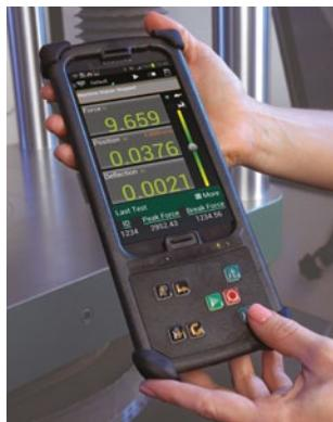
Подключаемый по Bluetooth беспроводной пульт управления с сенсорным экраном позволяет управлять испытанием с отображением численных результатов.
