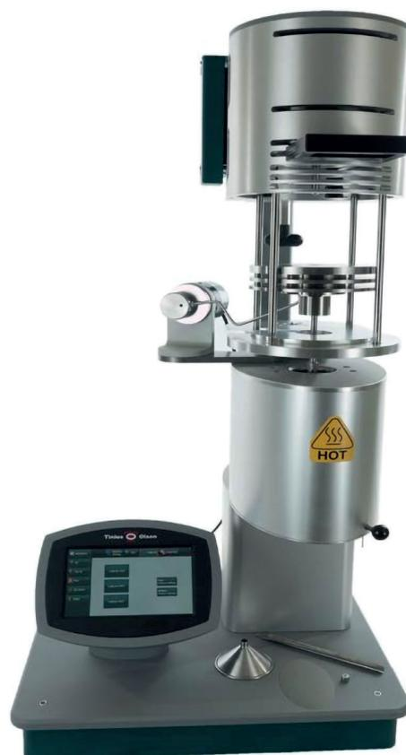
Прибор для определения показателя текучести расплава MP1200 с функцией автоматического подъема грузов с системой выбора груза.
