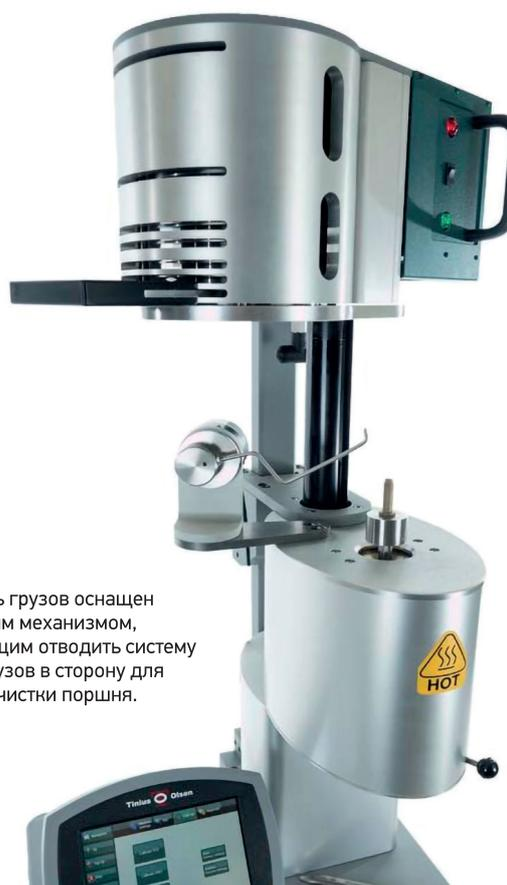
Держатель грузов оснащен поворотным механизмом, позволяющим отводить систему выбора грузов в сторону для снятия и очистки поршня.
