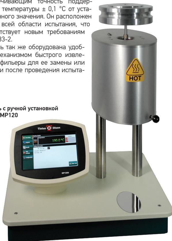
Модель MP1200 оснащается удобным в использовании цветным сенсорным ЖК-дисплеем. Оператор имеет возможность изменять параметры и пользовательские настройки программы (язык, единицы измерения, аварийные сигналы и т. п.). Существует настройка и сохранение индивидуальных протоколов испытаний. При настройке параметров испытаний, у оператора есть возможность из предварительно загруженного списка выбрать идентификаторы образца, либо создать собственные.
