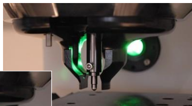
Моторизованная турель со встроенными инденторами, объективами и подсветкой
