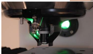
Моторизованная турель со встроенными инденторами, объективами и подсветкой
